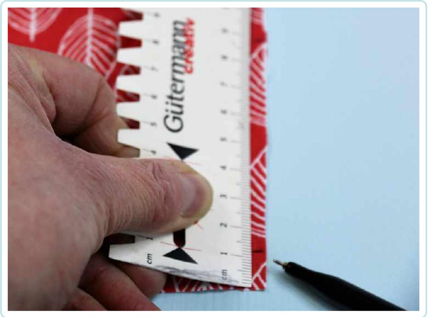
Zeichne eine Markierung auf dem Schnittteil aus Außenstoff: Je 1,5 cm von der oberen und unteren Kante entfernt an den schmalen Seiten.
